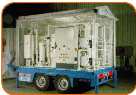
Appareil : MAXEI MASS 2000, débit : 2000 litres/heure
